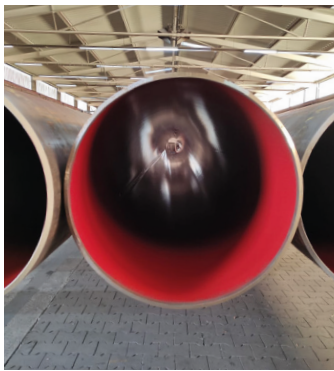
Flow Coat-Beschichtung auf der Rohrin-nenseite
